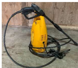
リョービ製高圧洗浄機 水道取り口が欠品
